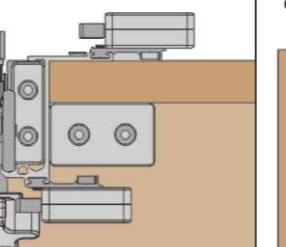
Закройте фиксатор предотвращающий соскальзывание ролика с направляющей
