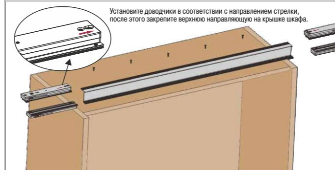
**6. Установите пластиковые фиксаторы и упоры**
