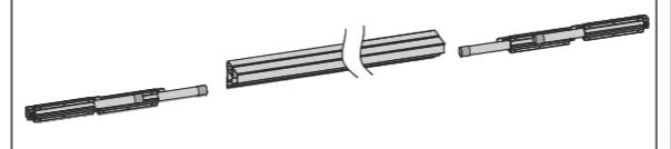
**8. Установка нижней направляющей в шкаф**
