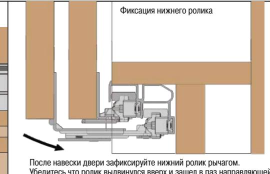
**11. Регулировка внешней и внутренней дверей**
